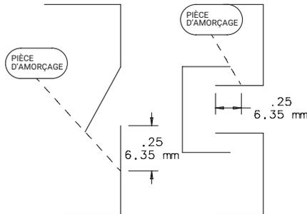
Un coupe-arc doit être fixé en place à l'aide de dispositifs mécaniques comme des attaches mécaniques.
