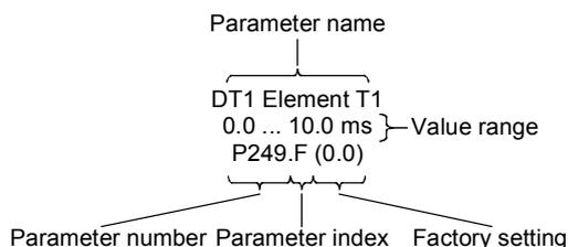
Fig. 4-5      *Function parameters*
