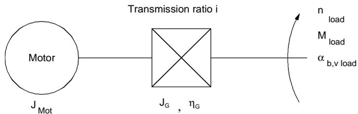
$$M_{Mot} = J_{Mot} \cdot i \cdot \alpha_{b,v \text{ load}} + J_G^* \cdot i \cdot \alpha_{b,v \text{ load}} + M_{load} \cdot \frac{1}{i \cdot \eta_G \cdot \text{Sign}(M_{load})}$$
