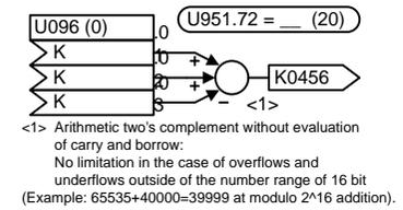
**1 modulo 2^32 adder/subtractor {1 μs}**
