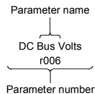
Fig. 4-7 Visualization parameters
